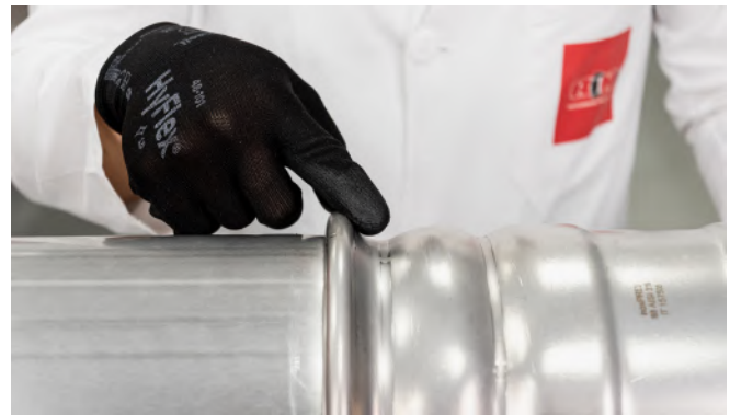
Afbeelding 36 – Visuele inspectie van overmaat persen
